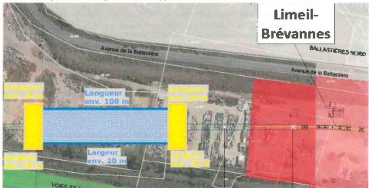
Figure 11 : Schéma type de la « zone d'épissure » de la boucle 1 du téléphérique Câble 1 (gestionnaire concerné : GPA)
